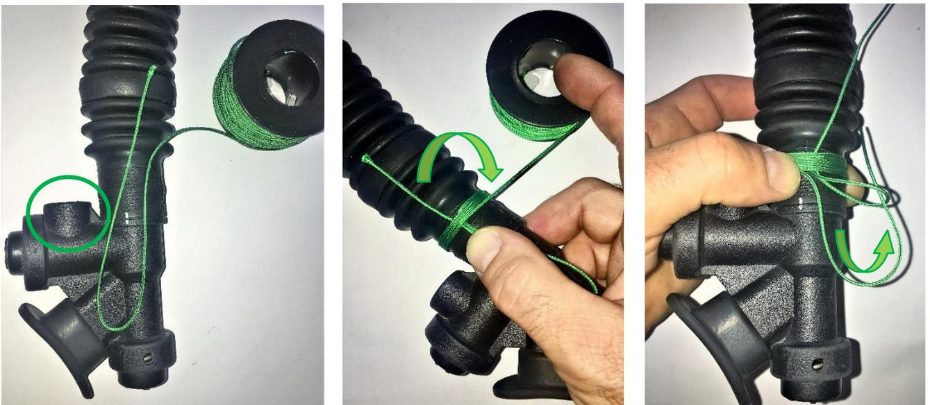
Abbildung 7, 8, 9: Entfernter Inflatoranschluss, Einbinden des Inflator, Führung der Schnur nach der Umwicklung
