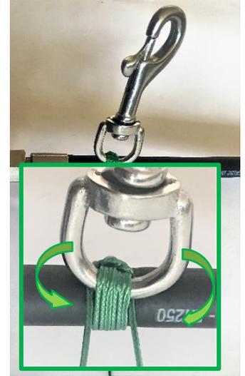
Abbildung 13, 14, 15: Einbinden des Karabiners, Einfacher Überhandknoten und die weitere Schnurführung auf die gegenüberliegende Seite unter dem Schekel entlang
