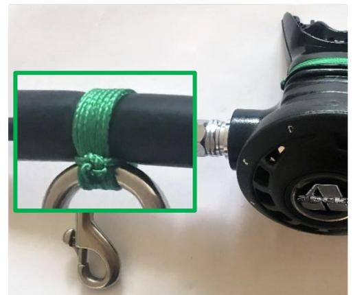
Abbildung 16: Abschließend sicher verknoten und die Bindschnurenden verschmelzen
