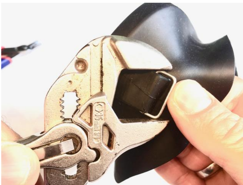
Abbildung 11: Einbau und Ausrichtung der neuen Klammer
