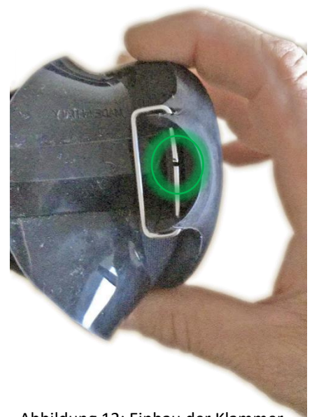
Abbildung 12: Einbau der Klammer am Kunststoff-Maskenkörper
