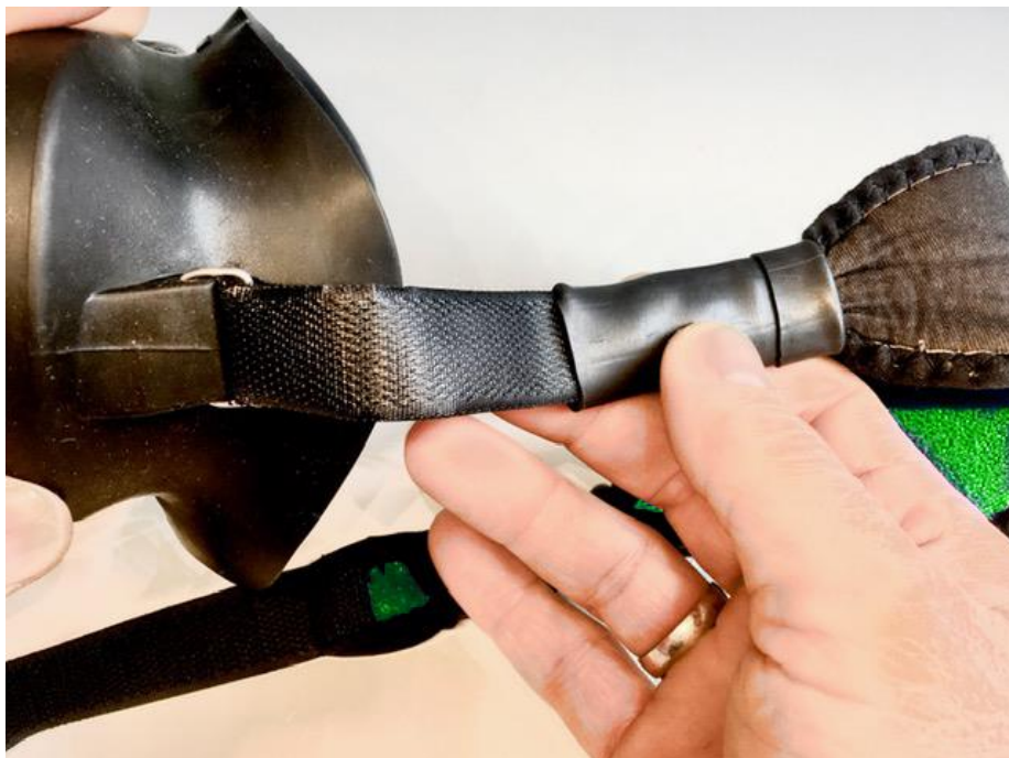
Abbildung 13: Endmontage mit Überzug aus Fahrradschlauch über den Klett-Bereich
