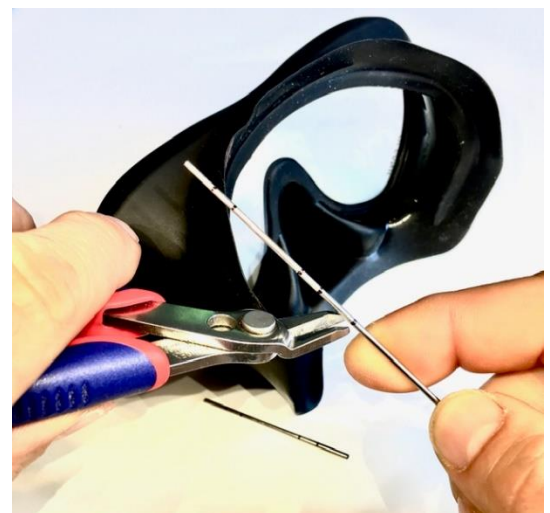
Abbildung 9: Ablängen des Edelstahlstabes
