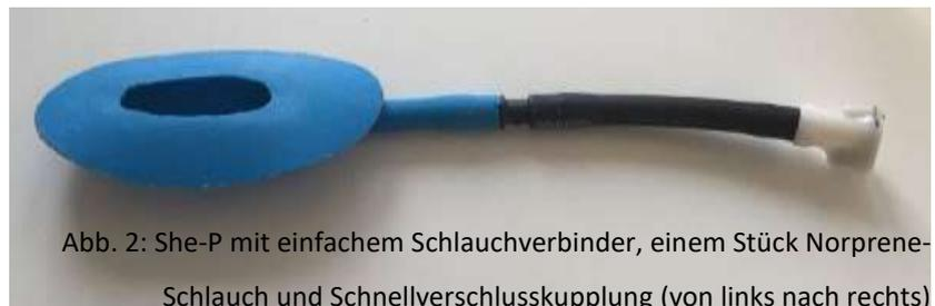
Abb. 2: She-P mit einfachem Schlauchverbinder, einem Stück Norprene-Schlauch und Schnellverschlusskupplung (von links nach rechts)
